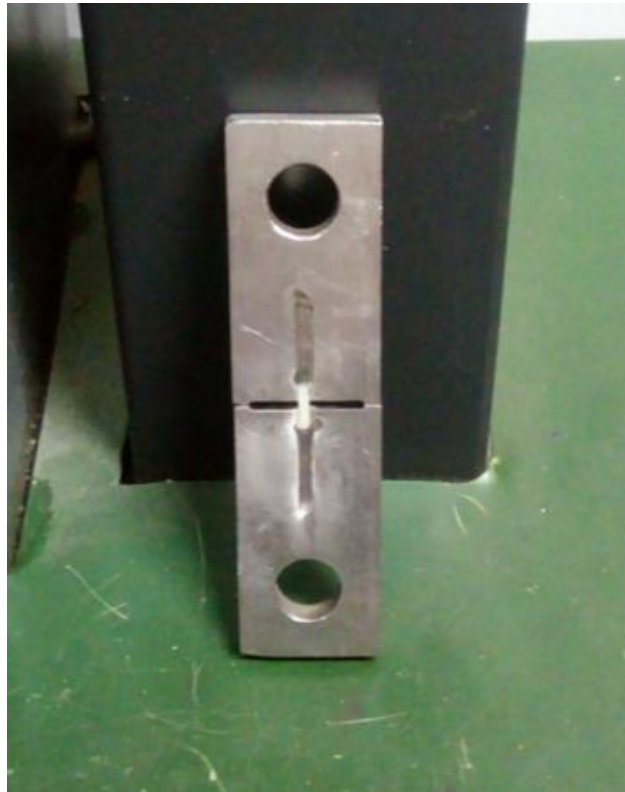
IMAGEN 20: MAQUINA DIGITAL DE ENSAYO UNIVERSAL CMT-5L DE MARCA LG PARA REALIZAR LA PRUEBA DE MICROTENSION
