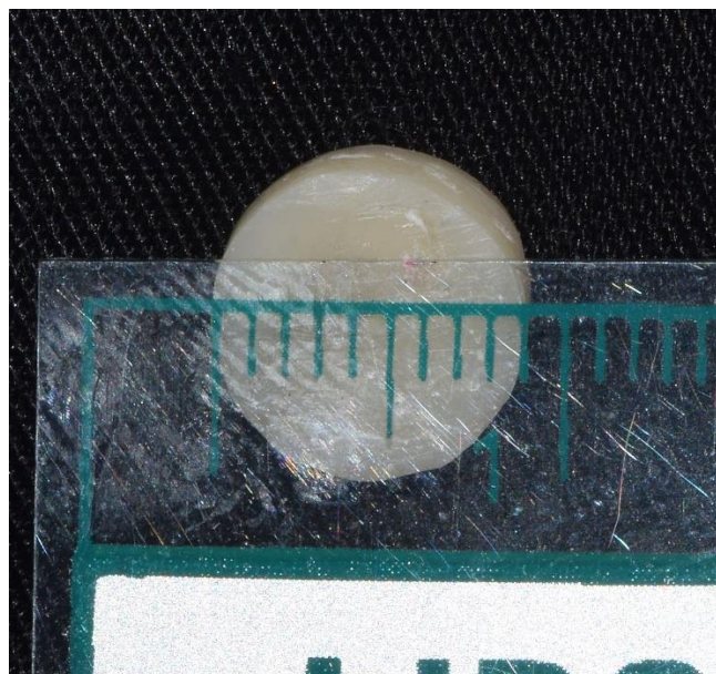
FIGURA 2: DISCOS DE RESINA DE LABORATORIO DE 9mm DE DIAMETRO PREMISE INDIRECT-KERR
