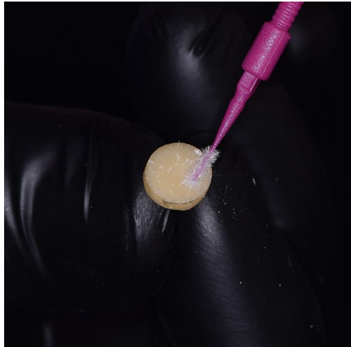
FIGURA 9: APLICACION DE MONOBOND N DURANTE 1 MIN EN SUPERFICIE DE DISCOS DE RESINA DE LABORATORIO
