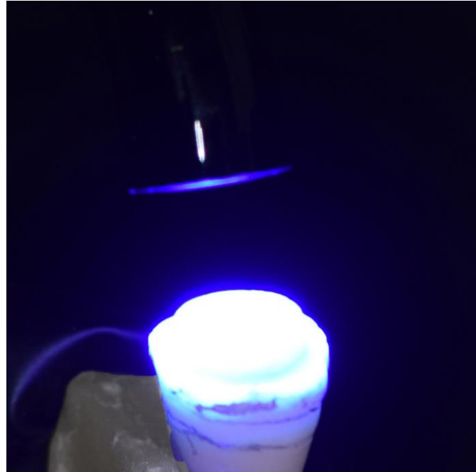
FIGURA 14: FOTOPOLIMERIZACION DE DISCOS DE RESINA DE LABORATORIO CON LAMPARA LED ELIPAR ESPE DeepCure -3M DE 1 470 Nw/cm 2 CON LONGITUD DE ONDA DE 430-480 nm, DURANTE 20 SEGUNDOS POR SUPERFICIE
