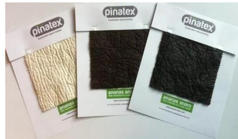
Para iniciar con el proceso primero se cortan por capas, luego se procesan como un textil, obteniendo así un rollo con diferentes grosores, según sea el requerimiento del cliente. La elaboración es sencilla y el desecho que esta produce se utiliza como fertilizante para los mismos agricultores de la localidad. Es un producto natural y amigable con el medio ambiente.
