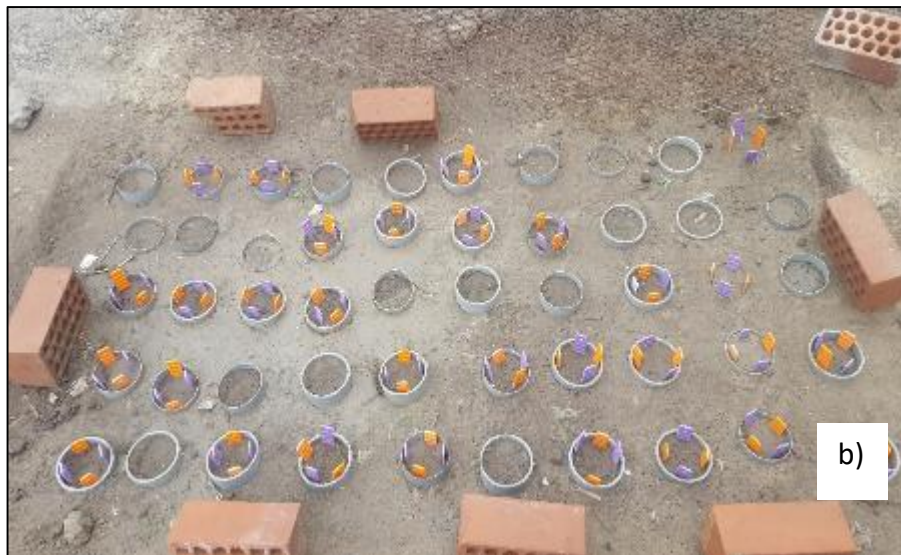
a) Sondas PRS y b) Ubicación de sondas PRS dentro de cada tubo de exclusión.
