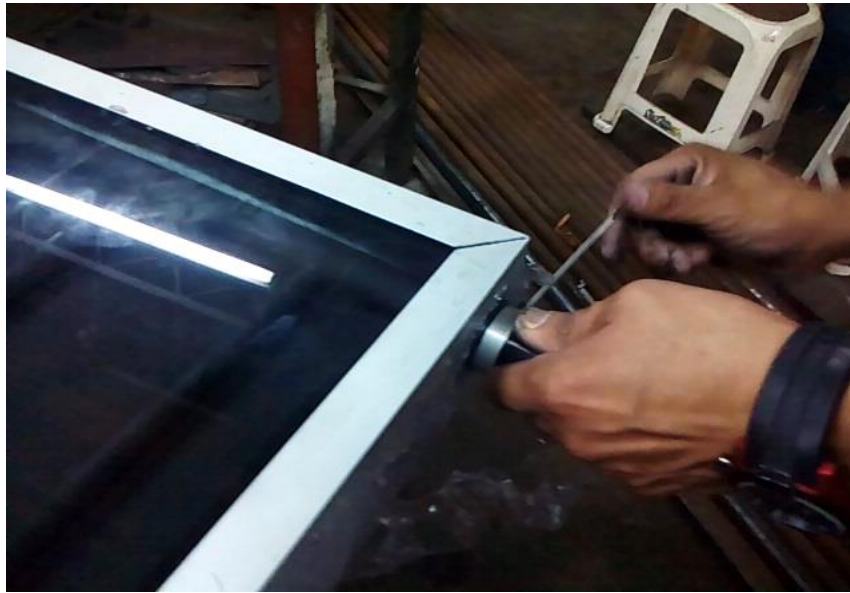
Figura 17. Cierres herméticos entre los extremos de la parrilla y la carcasa
