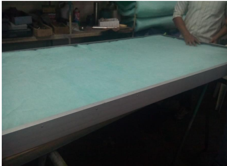
Figura 15. Colocación de aislante termoacústico
