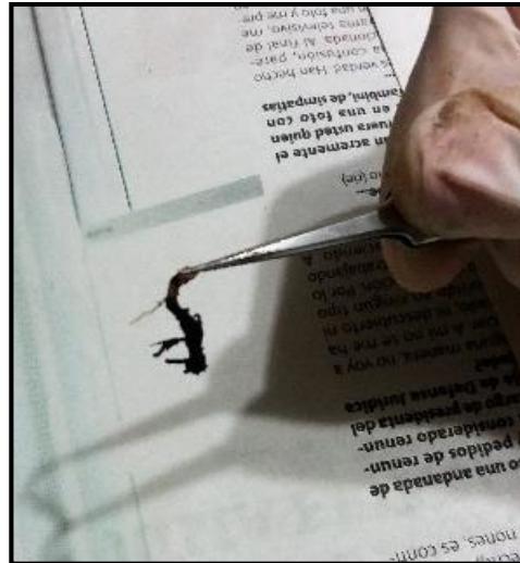
Figura 23. Separación de raíces, raíces finas y rizomas Muestra de raíz obtenida del estrato de 0 cm – 10 cm del suelo
