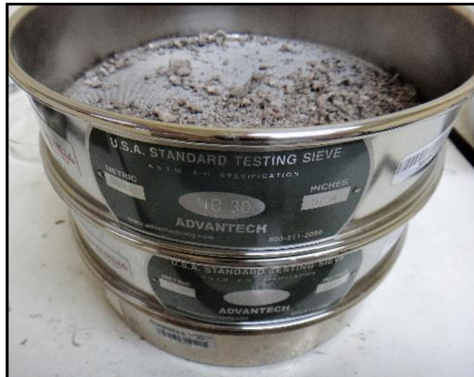
Figura 28. Tamiz Advantech de 600µm y 212µm Se utilizaron tamices de malla de alambre estándar y métrico de EE. UU. Estos tamices de prueba cumplen con todas las especificaciones de ASTM E - 11, AASHTO T - 27 y M - 27, NIST, ISO 3310 - 1 y BS 410.
