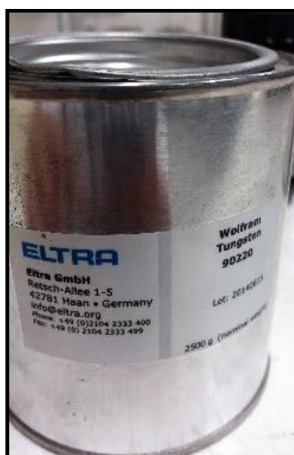
Figura 32. Tungsteno ELTRA Catalizador Eltra empleado en el análisis de carbono de las submuestras.
