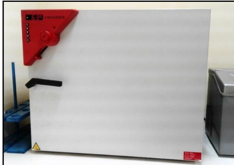
Figura 25. Estufa de secado Binder GmbH Estufa de secado en donde se colocaron las muestras por 72hrs a 60°C, o hasta llegar a peso constante.
