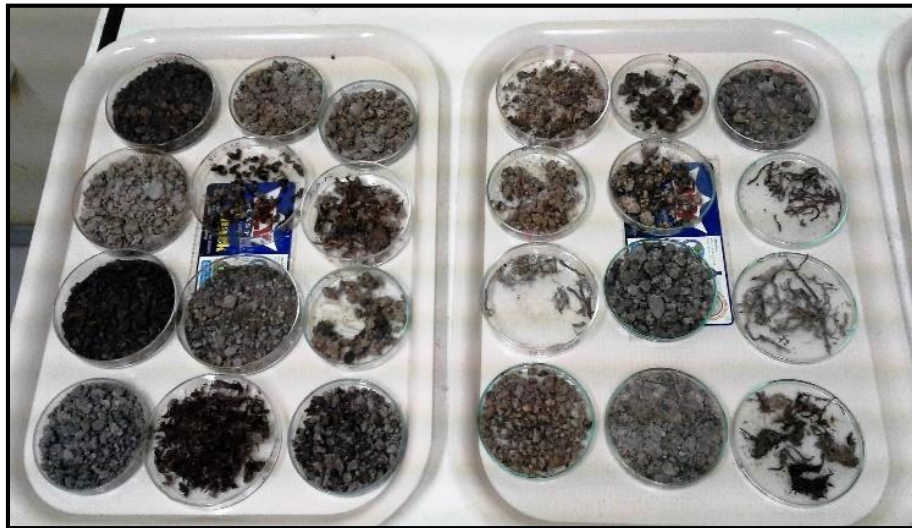
Figura 26. Muestras de suelo y raíces después de utilizar el método gravimétrico. Muestras debidamente rotuladas y separadas de los diferentes estratos de suelo evaluados en placas Petri.
