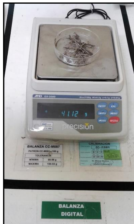
Figura 24. Balanza digital AND Serie GX 2000 Se utilizó la balanza digital debidamente calibrada para pesar las muestras frescas de biomasa herbácea, hojarasca/necromasa, raíces/rizomas y la materia orgánica del suelo.
