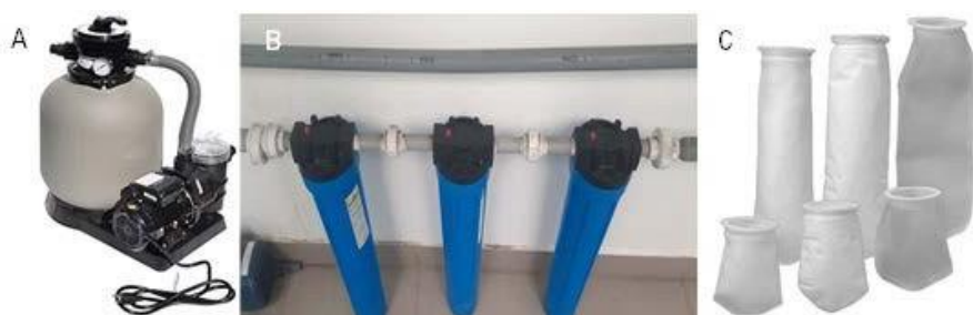
Figura 15. Filtros empleados en el hatchery del LICMA: A) arena, B) filtros de polipropileno y C) bolsas de poliéster
