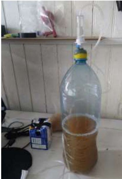
Figura 24 Generador de CO 2 a base de levadura
