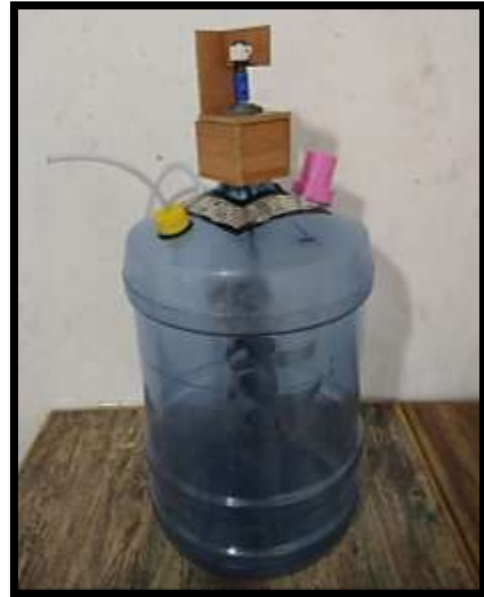
Figura 12 Prototipo final de un Biorreactor de 19L
