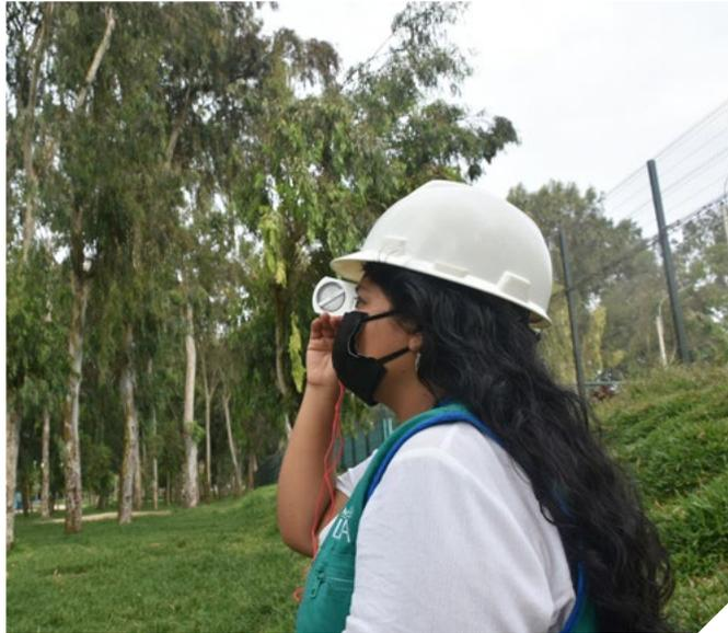
**Figura 5.** Medición de la altura del árbol con hipsómetro
