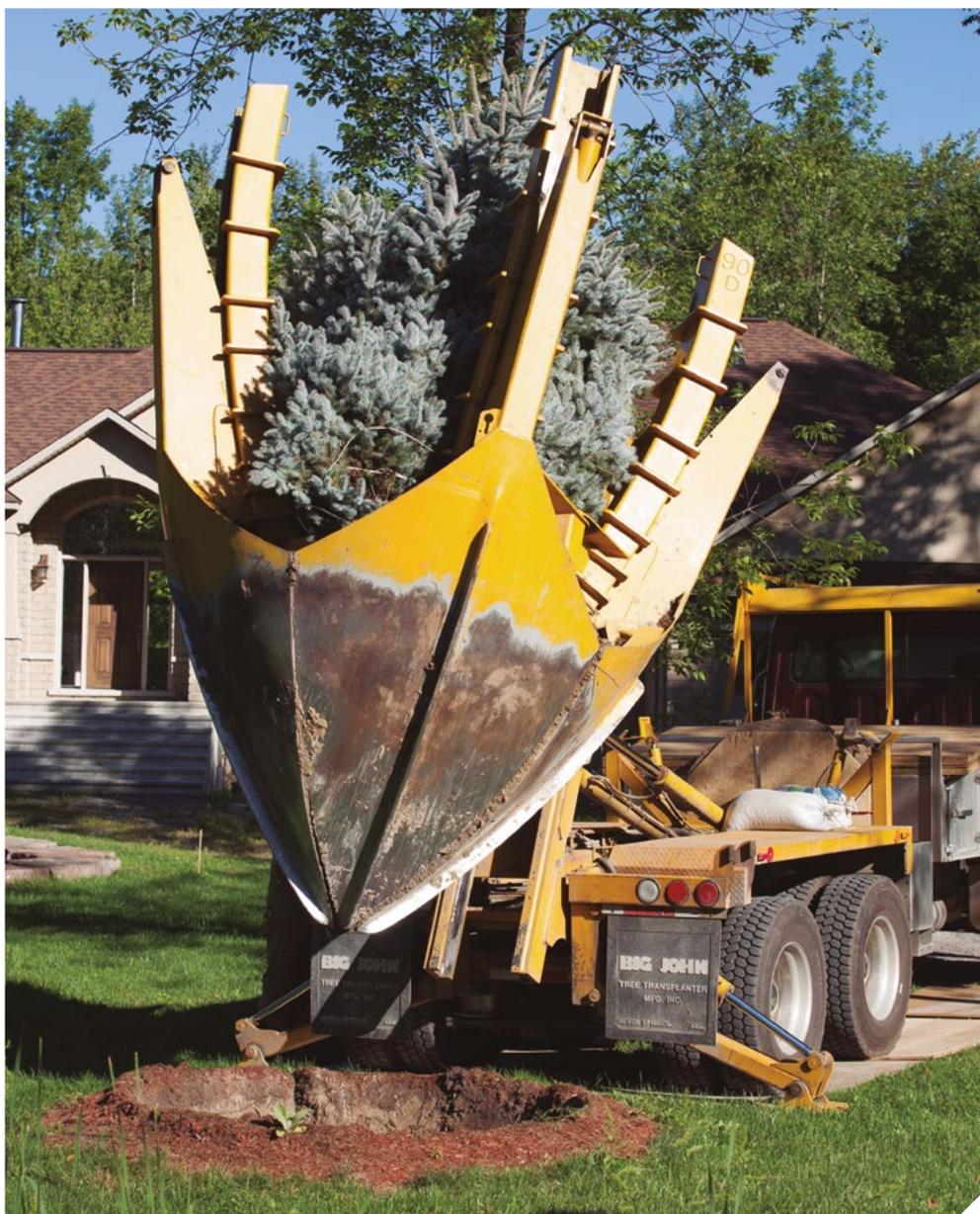
**Figura 5.** La extractora de árboles es una máquina montada en camión, ideal para operaciones de jardinería. Dispone de cuatro palas duraderas que penetran en el terreno y que pueden excavar, levantar y plantar árboles de hasta 13 cm o 5" de diámetro. Está diseñada para una mayor potencia y capacidad de maniobra.
