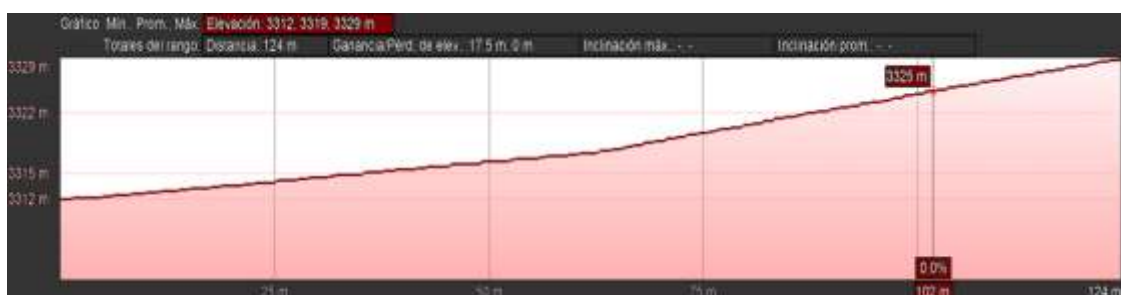
Figura 78 Pendiente del Terreno 2, corte A-A.
