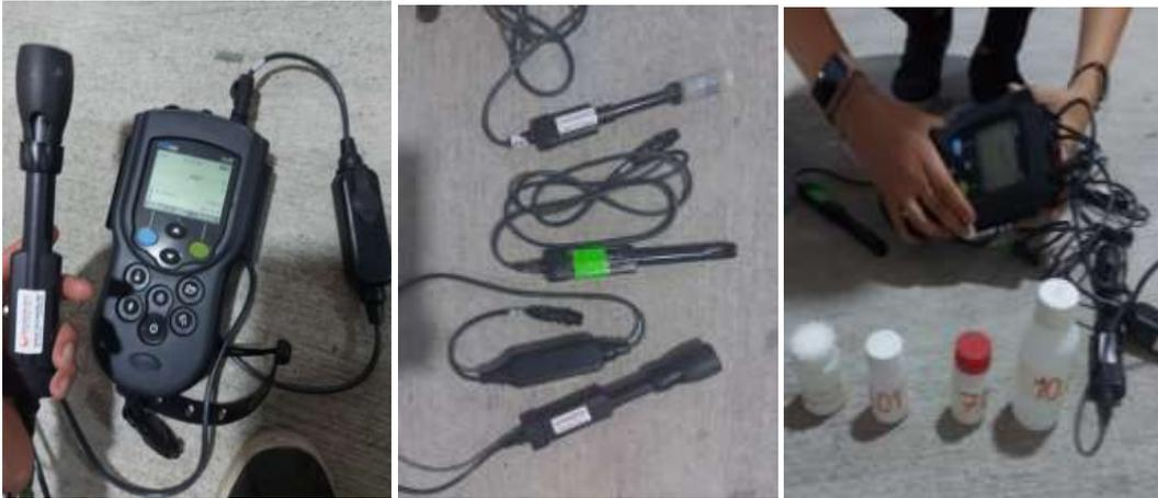
Imagen 3.- Fotografías del equipo multiparámetro junto a sus componentes
