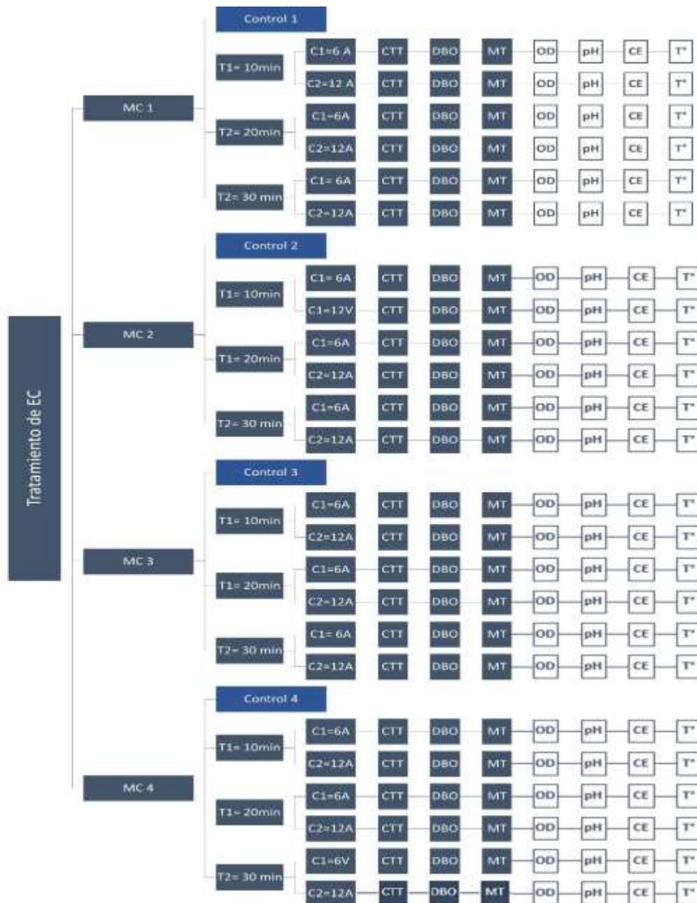
Figura 9.-Diseño, tamaño y selección de la muestra para la aplicación de los tratamientos con EC bajo diferentes corrientes eléctricas y tiempos.
