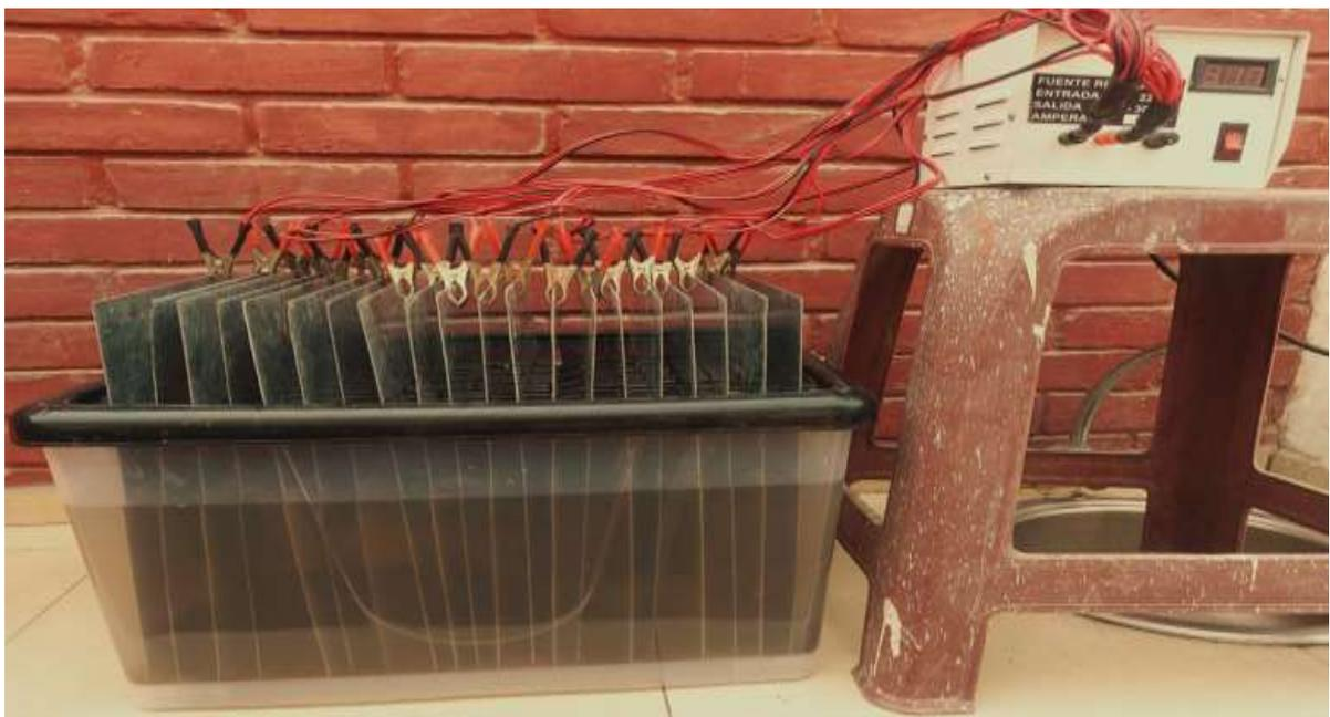
Imagen 1.- Conexión de electrodos a la fuente de poder mediante cables con pinzas positivos y negativos.
