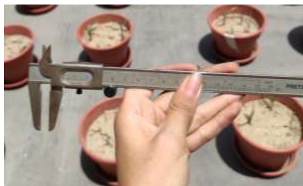
Figura 19. Vernier: Instrumento de medición de grosor de tallo
