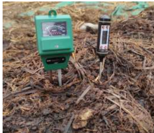
Figura 10. Termómetro especial para suelo y multiparámetro
