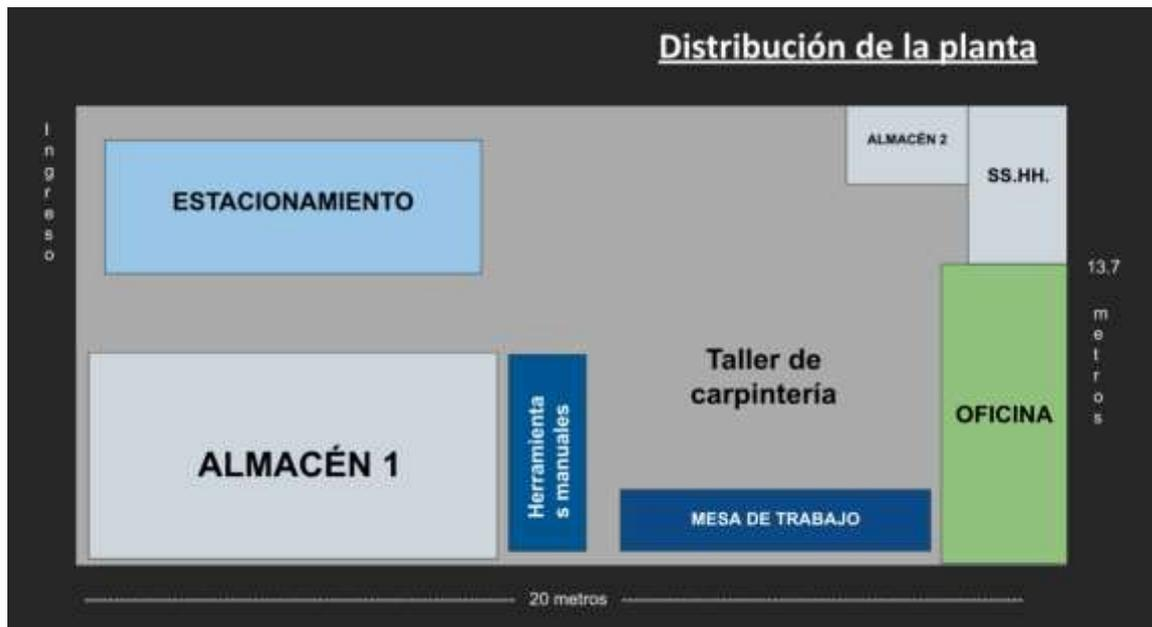
Figura 26. Lay Out de la planta.
