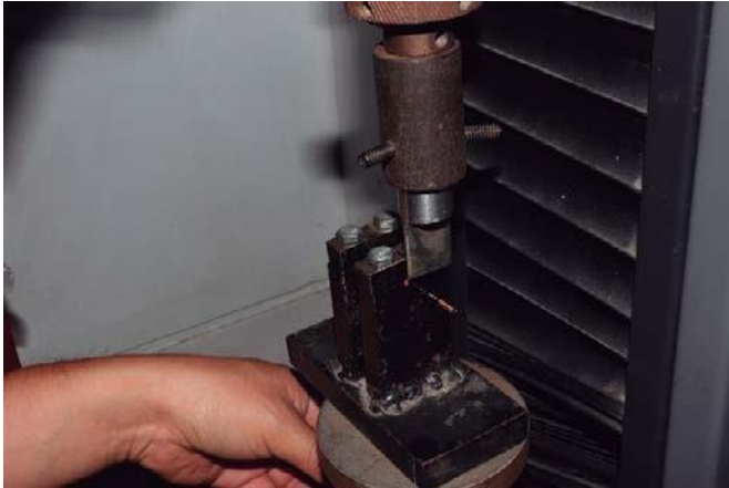
Figura 4 Punzón de la máquina computarizada de ensayo universal a 20 mm de la punta de la lima.
