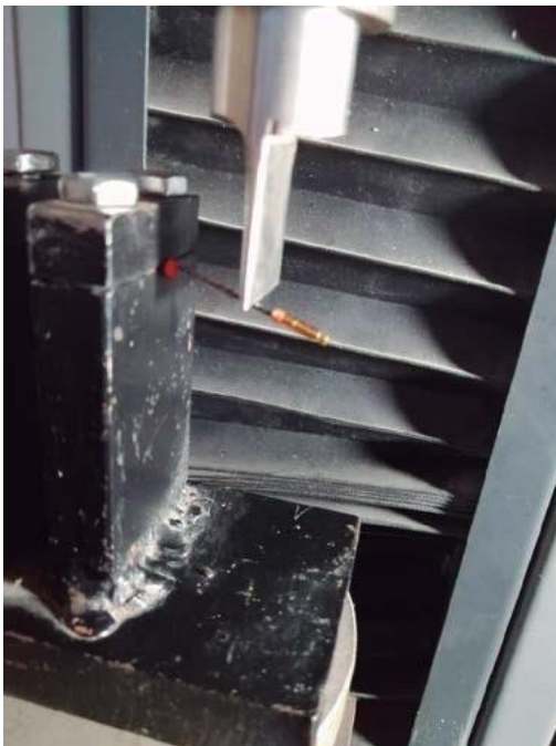
Figura 4 Punzón de la máquina computarizada de ensayo universal a 20 mm de la punta de la lima.
