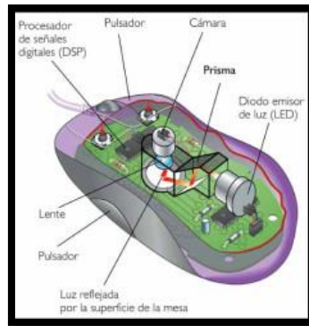
Ilustración 1: Partes generales de un mouse inalámbrico
