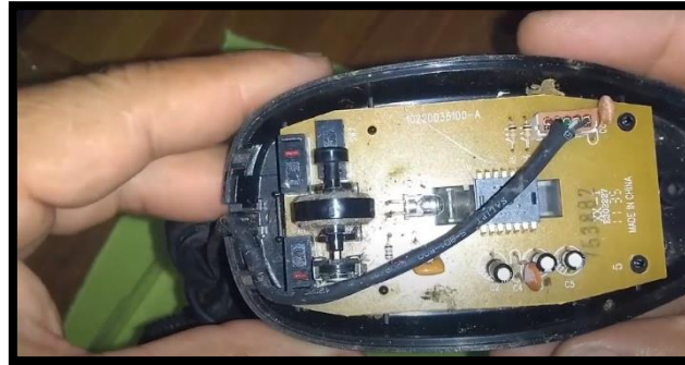
Ilustración 10 Estructura del hardware de un mouse para acoplarlo al LapiceroMouse
