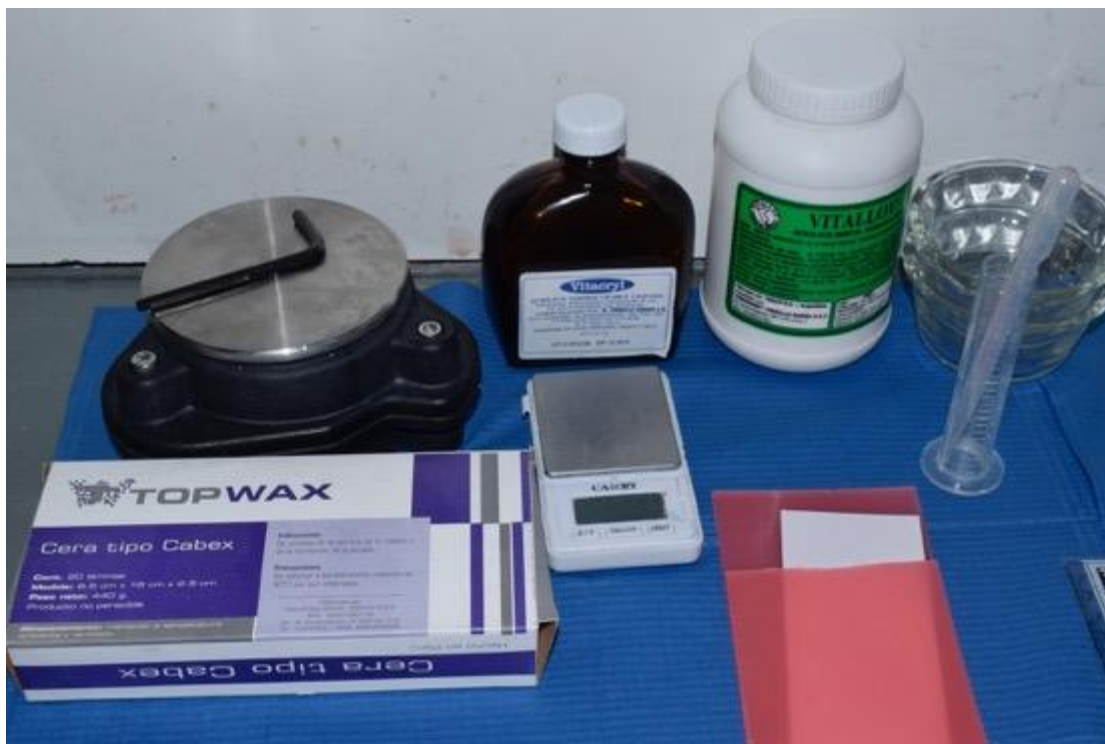
FIGURA 2 INSTRUMENTOS PARA REALIZAR LAS MEZCLAS DE LOS ACRILICOS.
