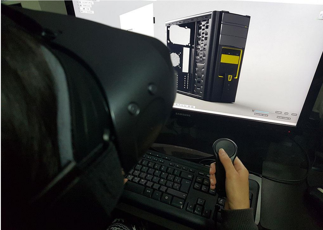
Fotografía 05: La Srta. diseñadora realizando cambios de materiales y texturas dentro del ambiente de realidad virtual.
