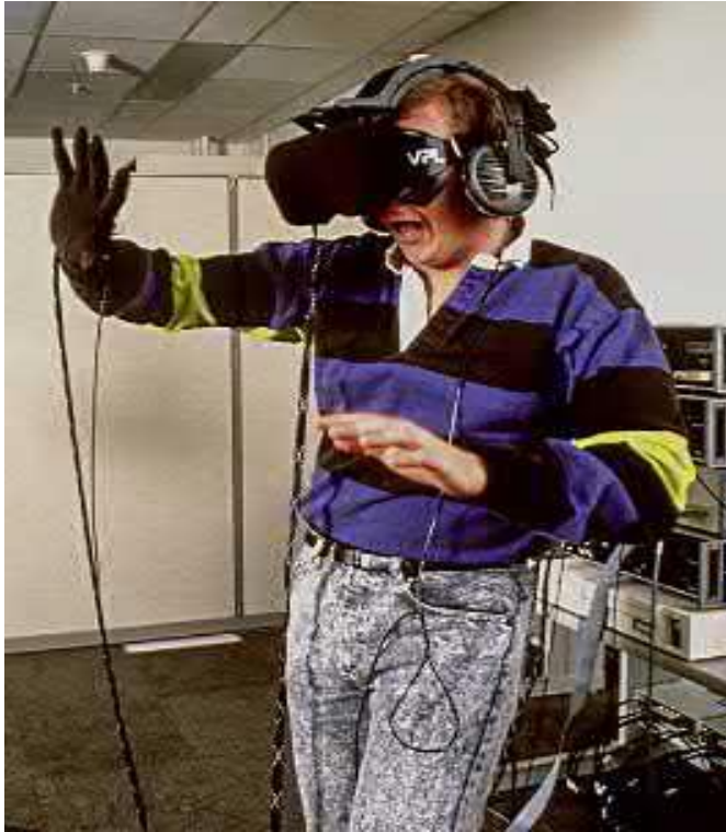
Figura 11. Usuario experimentando e interactuando con un mundo virtual utilizando los VPL Eyephones y Datagloves. [Imagen cortesía de NCSA] (2018). Recuperada de nca.illinois.edu .
