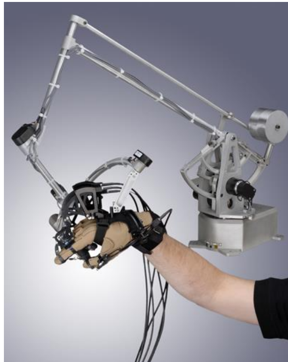
Figura 27. Sistema CyberForce integrado con el exoesqueleto CyberGrasp, permite sentir el peso y la inercia mientras se recoge objetos en el mundo virtual, también puede sentir la resistencia de una pared. Tomada de cyberglovesystems.com .
