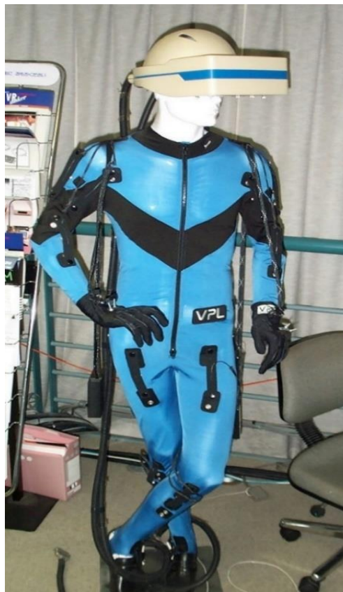
Figura 12. Imagen de Traje VPL con sensores de movimiento en piernas y brazos (2018). Recuperada de nca.illinois.edu .
