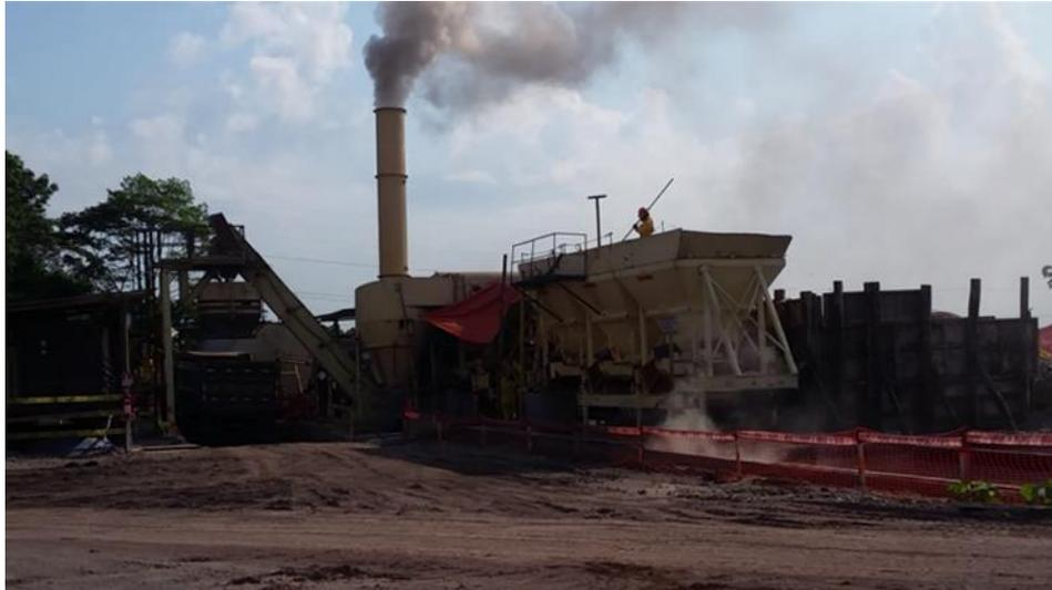
Figura 35: Plantas de producción de materiales (Asfalto)
