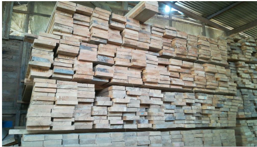
Ilustración 7. Bandas de 1" x 5" x 6.5ft preseleccionadas para la carga.
