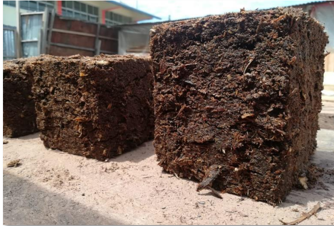
Ilustración 15. Briquetas producto de viruta o aserrín.
