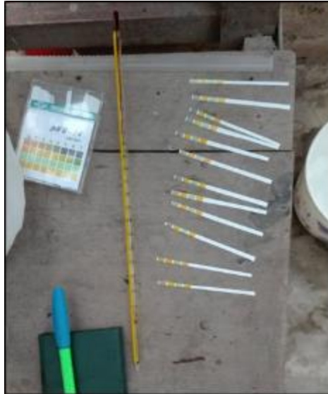
Figura 5. Medición de pH (tiras indicadoras) y temperatura (termómetro) en campo.
