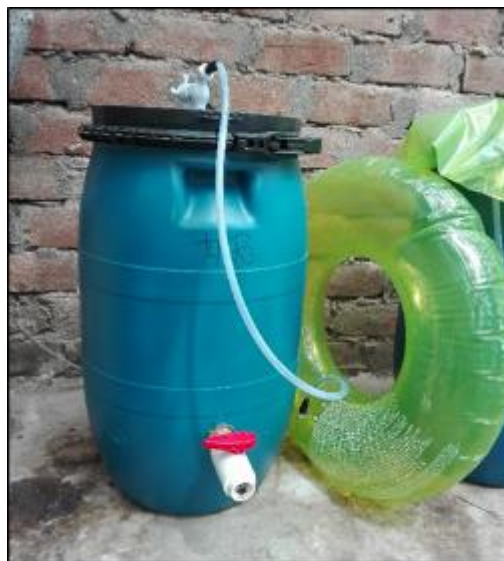
Figura 3. Construcción finalizada de un prototipo de biodigestor para la producción de abono líquido.
