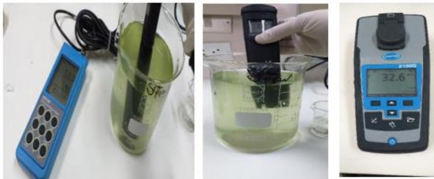
Figura 6. Medición de parámetros. Izquierda, medición con el oxímetro, centro, medición del pH y derecha, medición en el turbidímetro.
