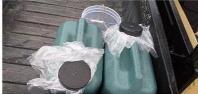
Figura 1. Toma de muestra: Se recolecto las muestras en dos galones de 20 litros, de la laguna después del tratamiento preliminar y lagunas aireadas.
