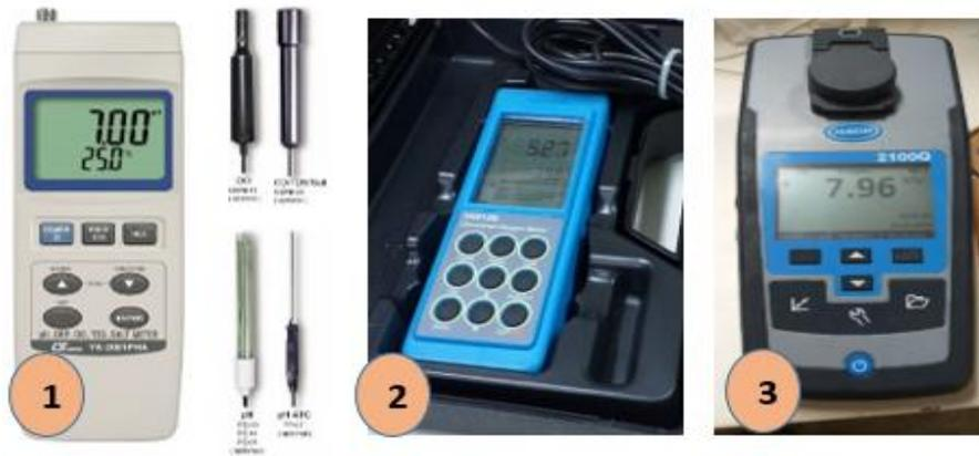
Figura 5. Instrumentos de Medición: Izquierda: Multiparámetro, centro. medidor de oxígeno disuelto y derecha. Turbidímetro.
