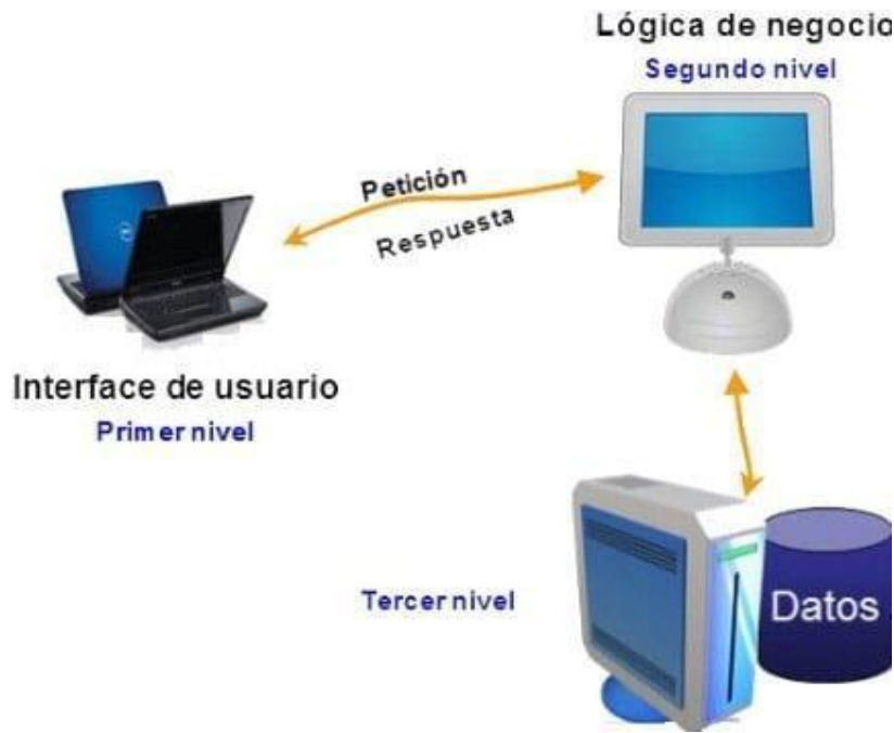
Figura N°4: Arquitectura de 3 capas
