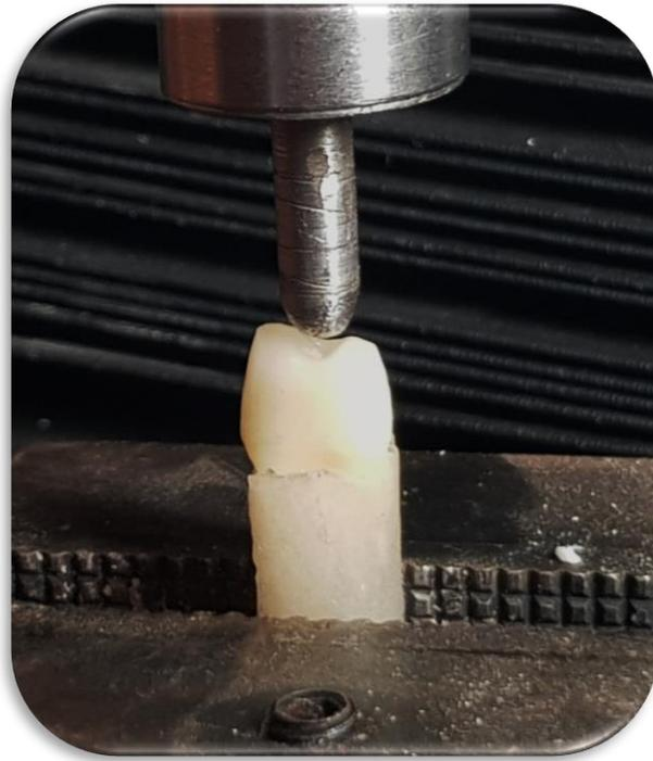
Prueba de resistencia a la compresión en maquina universal (LG CMT 5L)
