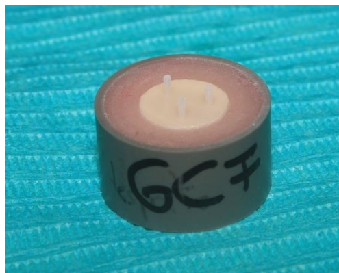
Fig. 8g Vista fotográfica de la adhesión de los 3 cilindros resinosos a la superficie cerámica.
