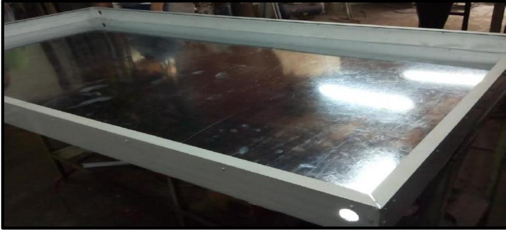
*Figura 21: Carcasa del Captador*
