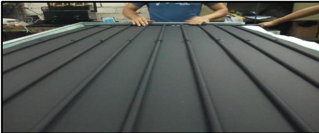
*Figura 23: Pintado de la capa aislante y plancha de Acero LAF*
