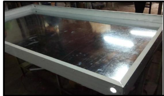
*Figura 29: Carcasa del captador*
