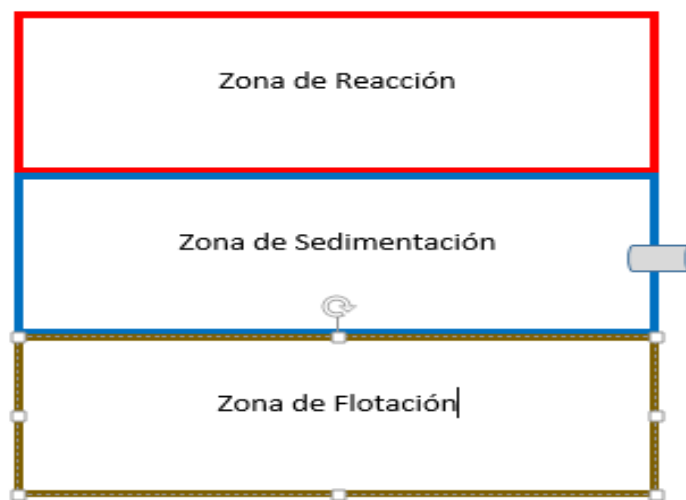
Figura 1. Esquematización del orden de las Zonas en las que se divide la Celda de Tipo Batch para el tratamiento de electrocoagulación.
