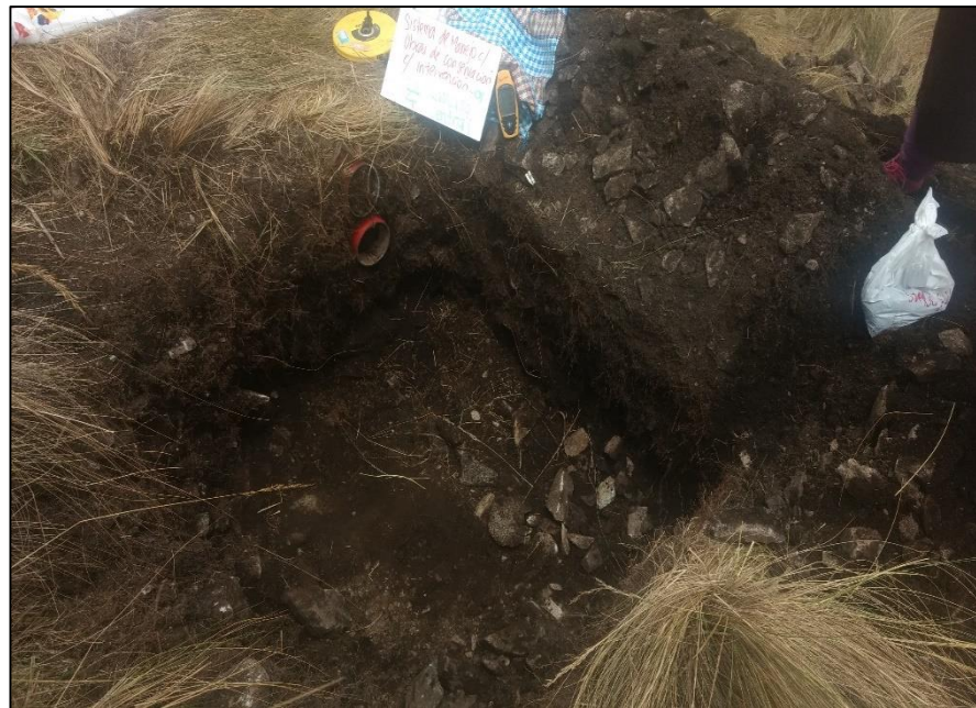
Figura 15 Determinación de profundidad para densidad aparente 50 cm.
