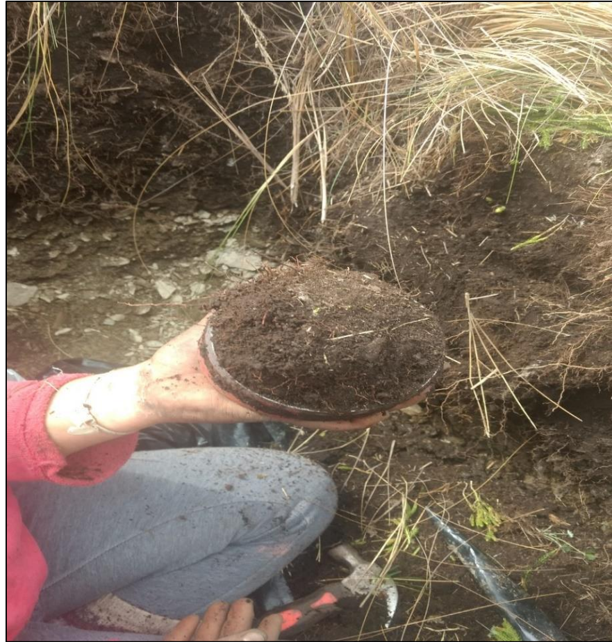
Figura 14 Suelo extraído con el cilindro de Uhland para la determinación de densidad aparente
