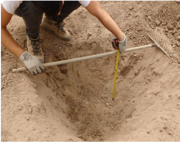
Calicata para muestreo de suelo
