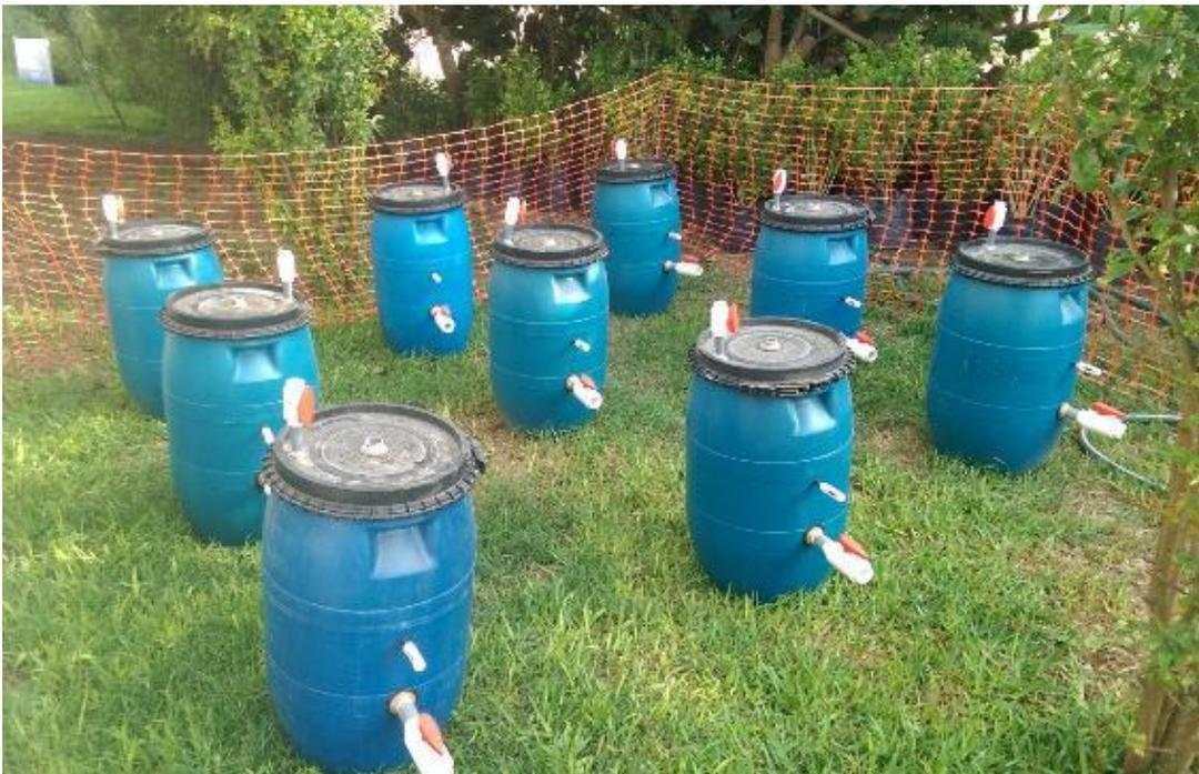
**Figura 5:** Biodigestores tipo Batch utilizados
