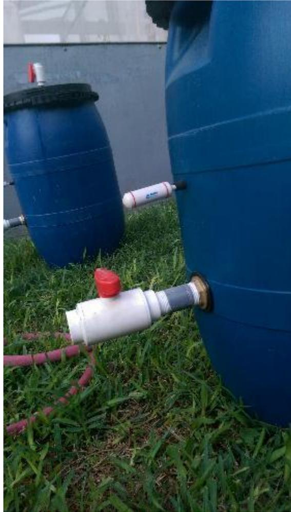
Conexión de la llave de salida del efluente y los termómetros
