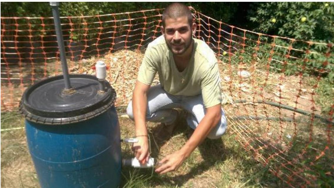
Extracción del efluente de los biodigestores para registro de pH
