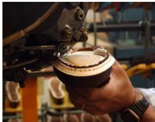
Figura 10. Cocido de empeine y forro a la plantilla (ejemplo).
