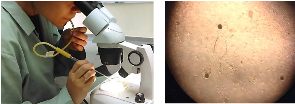
Figura 8. Desnudamiento de ovocitos con pipeta pasteur modificada (Fuente: propia).
