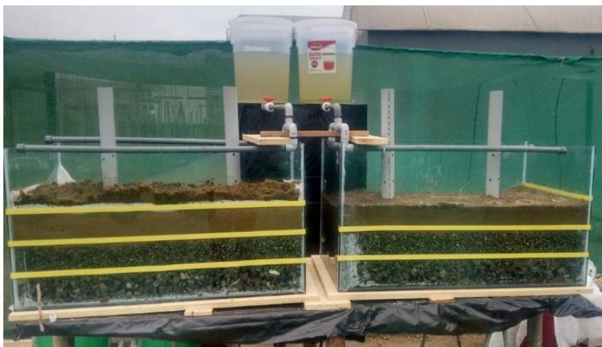
Figura 22: Instalación de tanques sobre los biofiltros.
