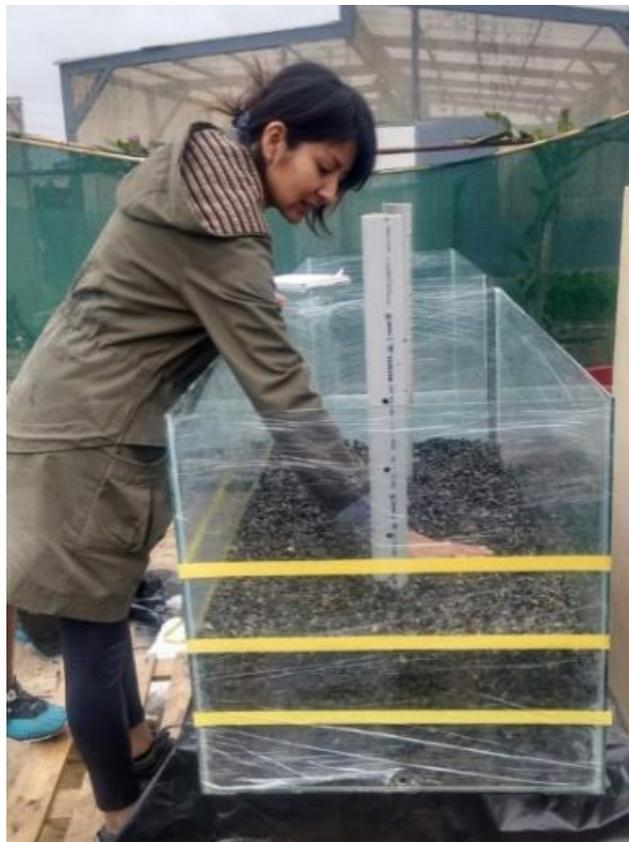
Colocación de agregados en los biofiltros.
