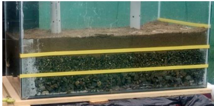
**Figura 18:** Vista del biofiltro convencional
