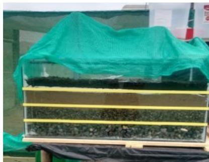
Figura 53: Instalación de malla ratchet sobre el biofiltro con *Eisenia foetida*.
