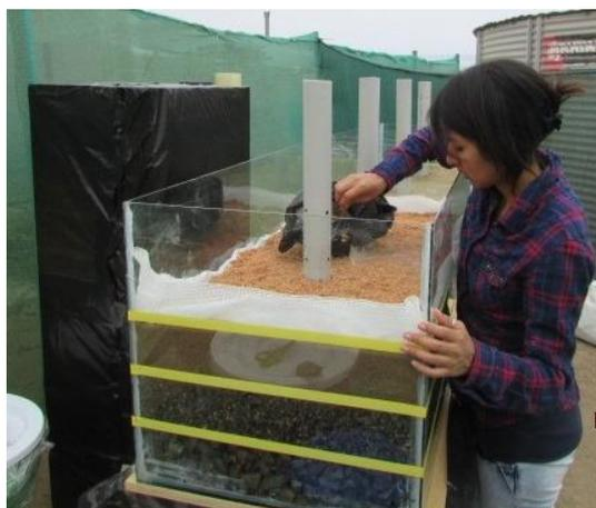
**Figura 14:** Colocación de aserrín en el biofiltro.
