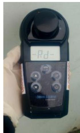
Figura 26: Turbidímetro Thermo Orion AQUAfast AQ3010
