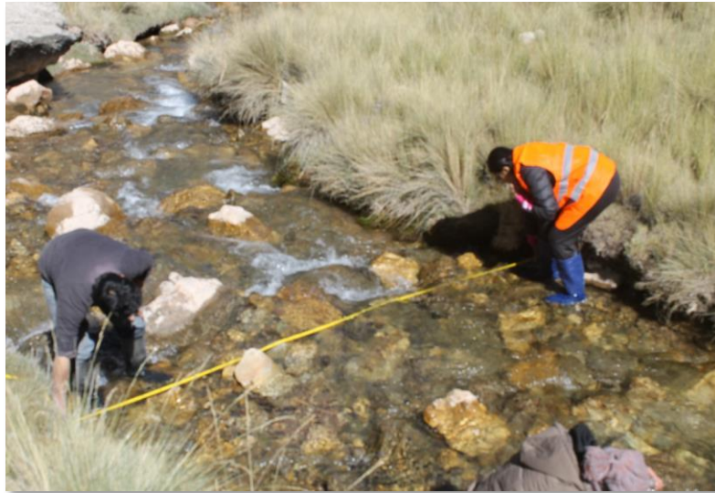
Figura 94. Medición del ancho del río para la hallar el caudal
