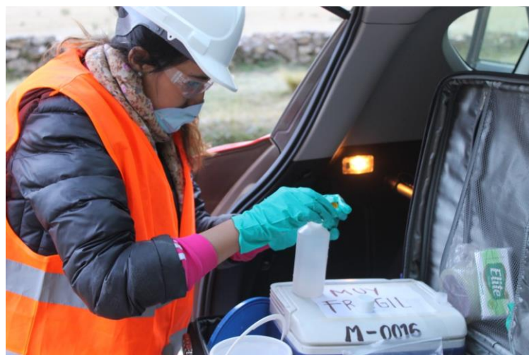
Figura 93. Preservación de la muestra de agua con ácido nítrico \text{HNO}_3 a 0.1 mL
