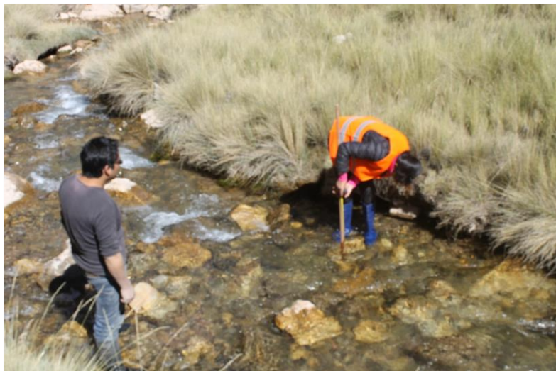
Figura 95. Medición de la profundidad del río para la medición del caudal
