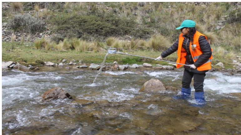
Figura 96. Toma de muestra de agua con brazo extensor en época de avenida en la estación E2
