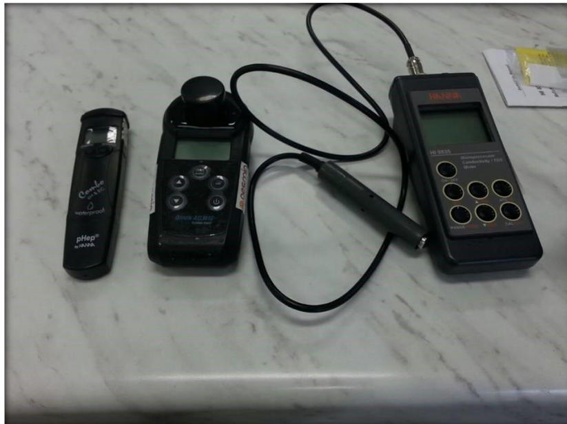
Figura 1. Potenciómetro, turbidímetro y conductímetro empleados en las mediciones durante la ejecución del experimento.
