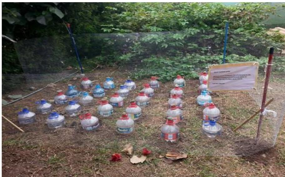
**Figura 1.** Instalación de 30 sistemas Kondenskompresor (KDK), en las inmediaciones de la Universidad Científica del Sur, para evaluar el efecto de la turbidez en la remoción del plomo en agua.
