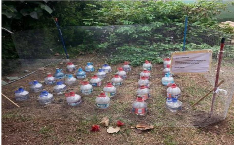
Figura 1. Instalación de 30 sistemas Kondenskompresor, en las inmediaciones de la Universidad Científica del Sur, para evaluar el efecto de la turbidez en la remoción del plomo en agua.
