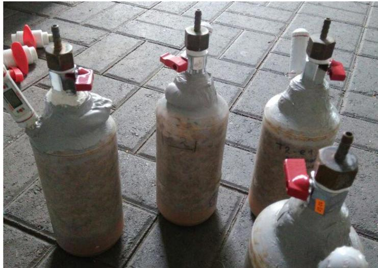
Figura 12: Burbujas en los biodigestores
