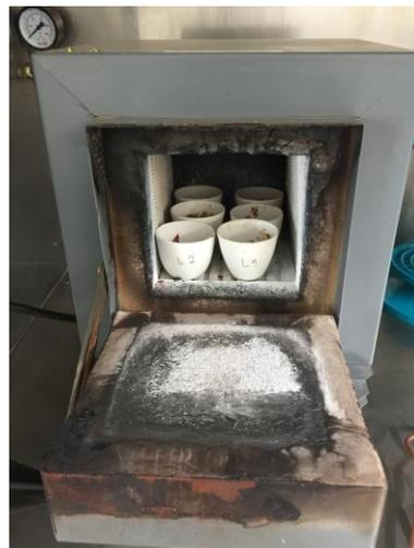
Figura 27: Muestras de bagazo y levadura en la mufla a 550°C.
