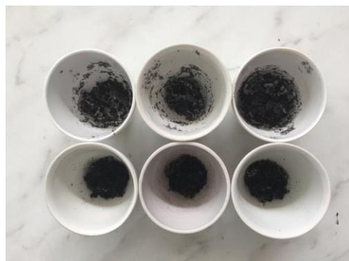
Figura 28: Muestras de bagazo y levadura luego de dos horas en la mufla.
