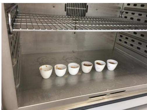
Figura 24: Muestras de bagazo y levadura en la estufa a 105°C.
