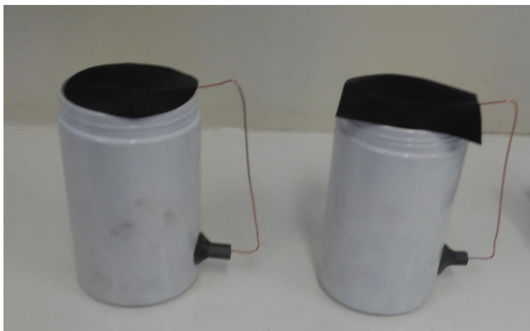
Figura 7-3: Vista frontal de reactores, el de la derecha con carbon cloth y el de la izquierda con carbon paper
