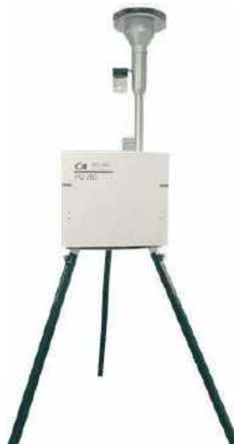
Figura 5. Muestreador de bajo volumen para PM 2.5 marca BGI PQ200
