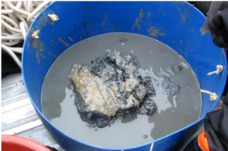
**ANEXO 4:** Muestra obtenida mediante dragado. Se observa la coloración oscura del sedimento fangoso.
