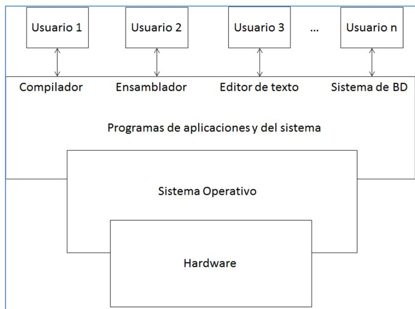
Figura 4: Perspectiva abstracta de los componentes de un sistema de computación.
