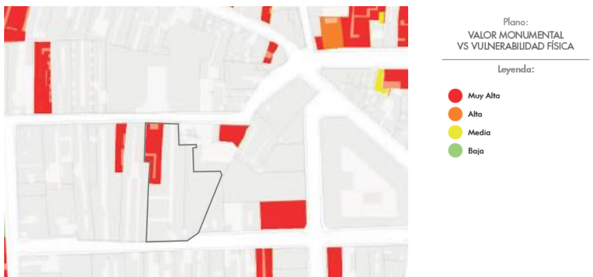
Plano de identificación de vulnerabilidad física de los inmuebles de valor monumental.
