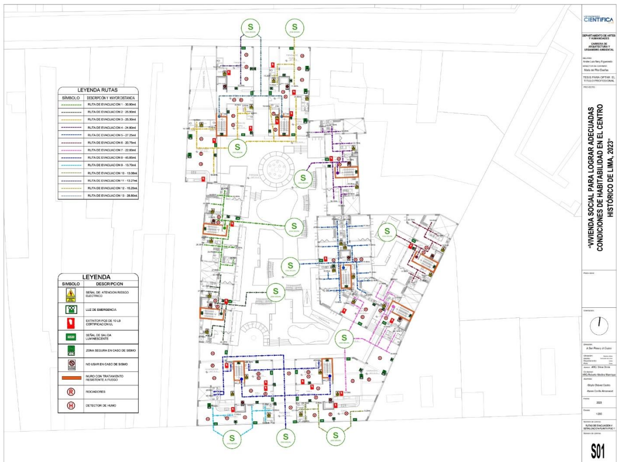
Plano de señalización y rutas de evacuación
