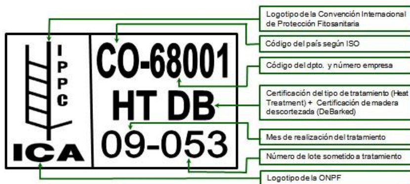
Gráfico 22: Sello fitosanitario para el palet de madera
