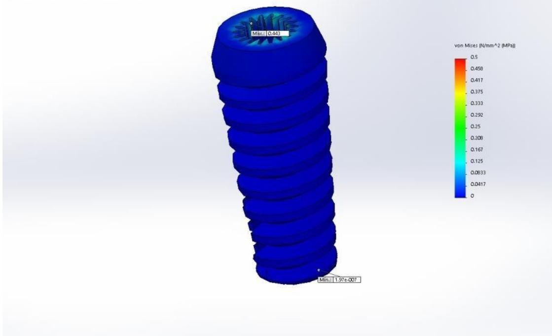
**Gráfico 1:** Análisis de Von Mises que evaluó la tensión compresiva (MPa) en el implante con conector ranurado.
