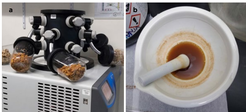
Figura 10. Liofilización de las muestras. a. Muestras previamente congeladas a -35\text{ }^{\circ}\text{C} en frascos de 250 ml conectadas al sistema de múltiples válvulas para liofilización. b. Pulverización de la muestra seca con la ayuda de un mortero y pilón.
