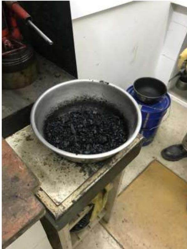
11.14 Fotos de prueba de adherencia del asfalto
