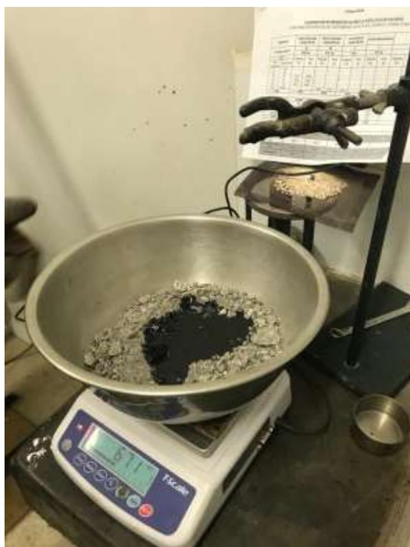
11.13 Fotos de las mezclas del asfalto con los agregados finos
