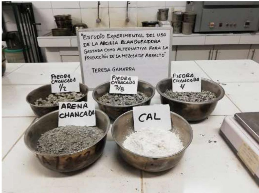
11.12 Fotos de los agregados árido más el peso del betún asfáltico 60/70
