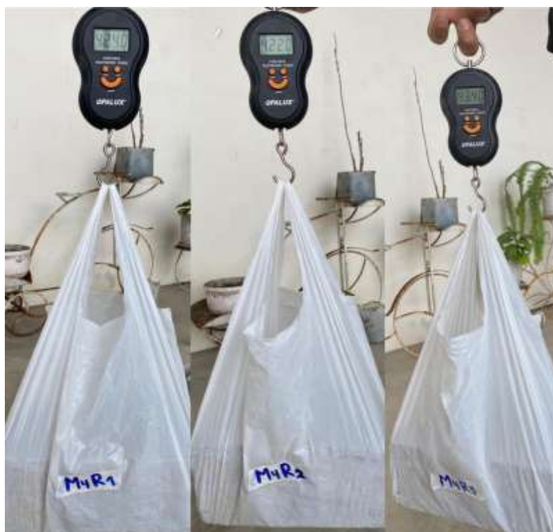
Figura 28. Prueba física de la Muestra - Peso PET 55%.
