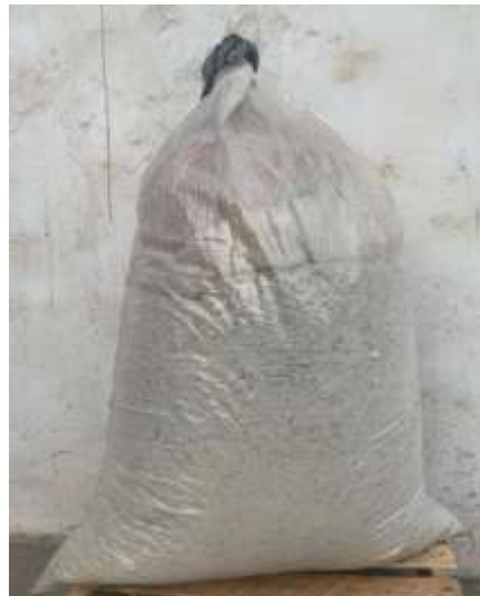
Figura 8. Almacenamiento del polvillo de PET.
