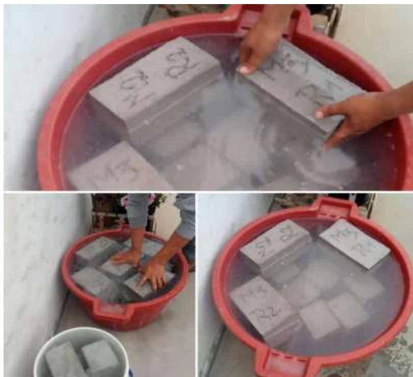
Figura 22. Curado de ladrillo por un periodo de 7 días.
