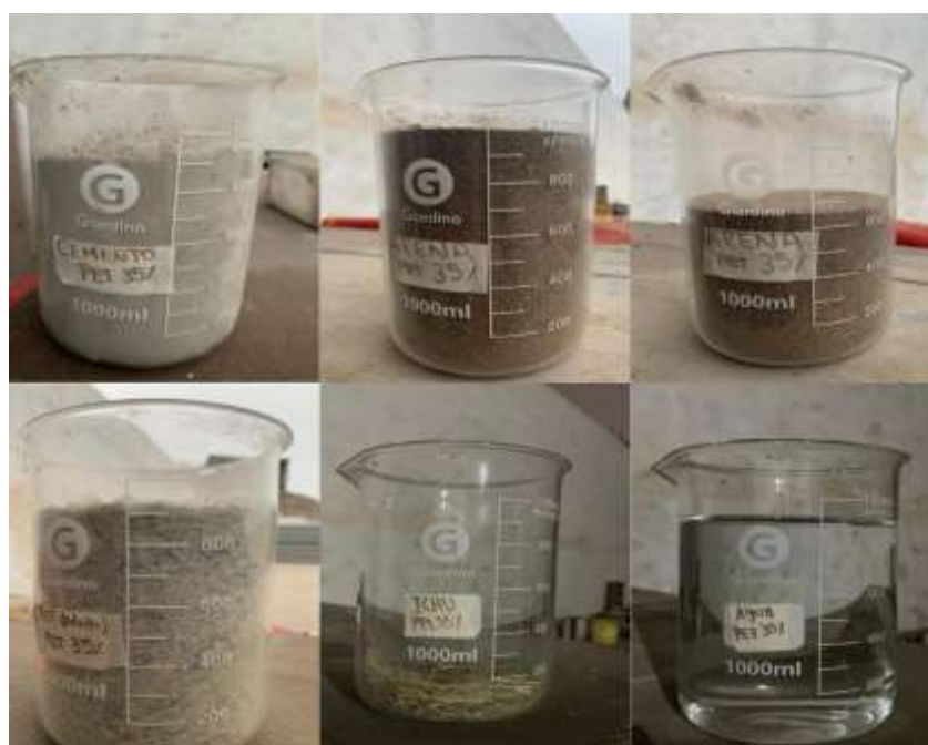
Figura 13. Medición de volúmenes de la muestra PET - 35%
