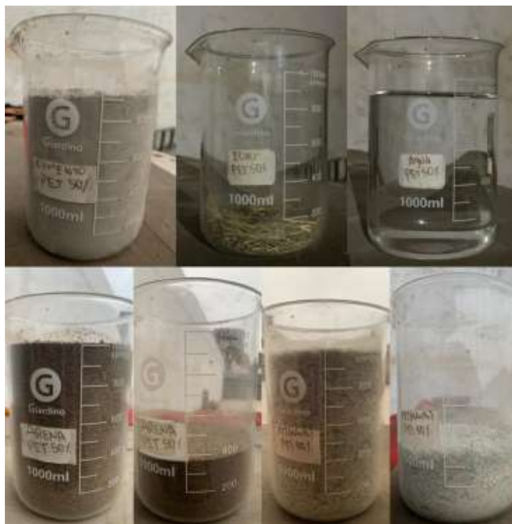
Figura 17. Medición de volúmenes de la muestra PET - 55%
