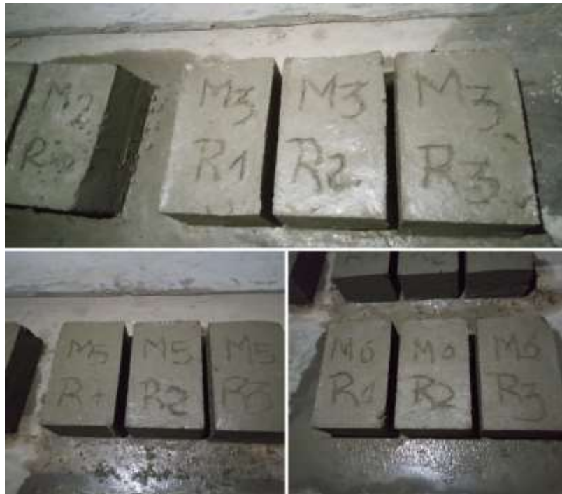
Figura 22. Curado de ladrillo por un periodo de 7 días.
