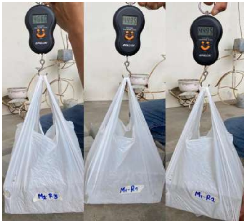
Figura 25. Prueba física de la Muestra - Peso PET 40%.
