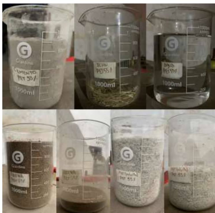
Figura 17. Medición de volúmenes de la muestra PET - 55%
