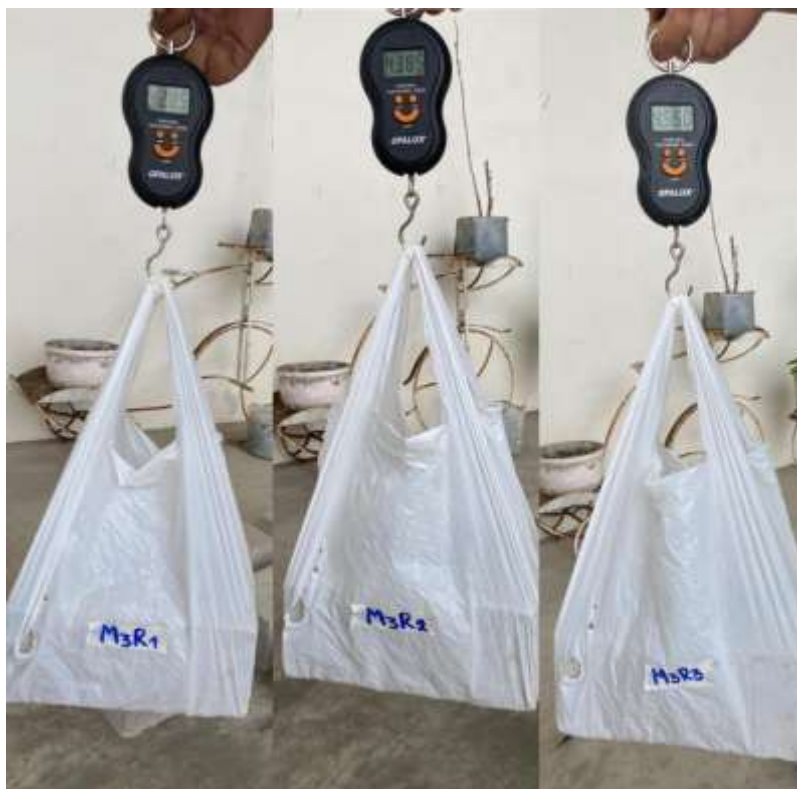
Figura 27. Prueba física de la Muestra - Peso PET 50%.
