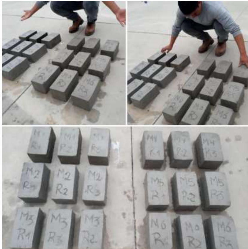
Figura 23. Secado del ladrillo a temperatura ambiente durante 20 días.
