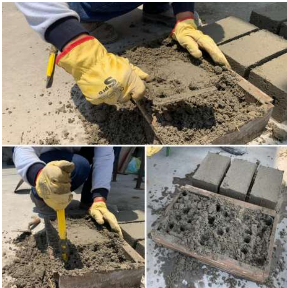
Figura 20. Compactación manual del mortero.
