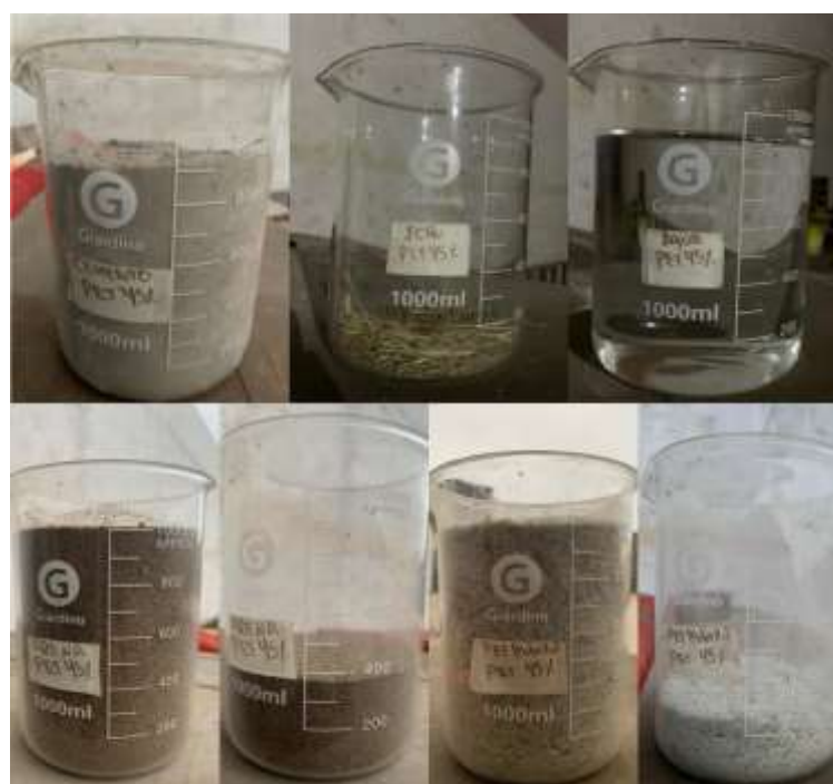
Figura 15. Medición de volúmenes de la muestra PET - 45%
