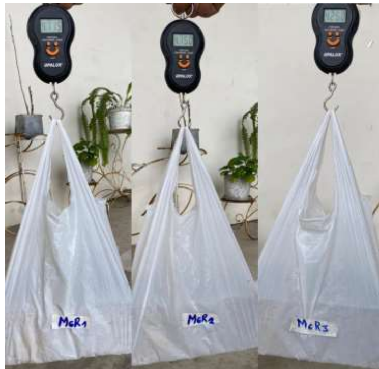
Figura 29. Prueba física de la Muestra - Peso PET 60%.
