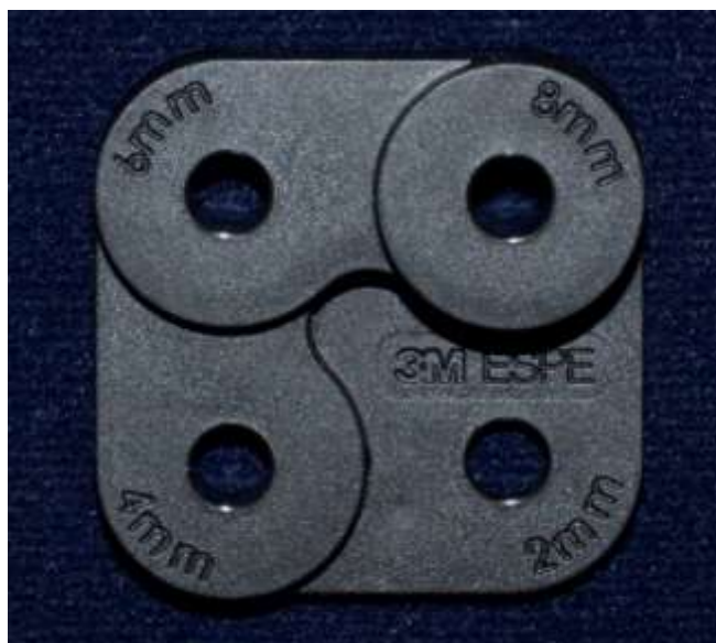
FIGURA 1: MATRIZ PREFORMADA PARA LA CONFECCIÓN DE LOS ESPECIMENES
