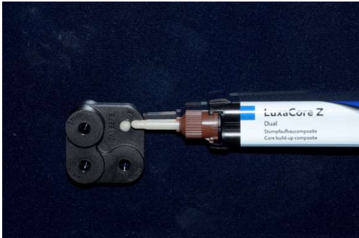
FIGURA 2: COLOCACION DE LOS BIOMATERIALES PARA LA CONFECCIÓN DE ESPECIMENES
