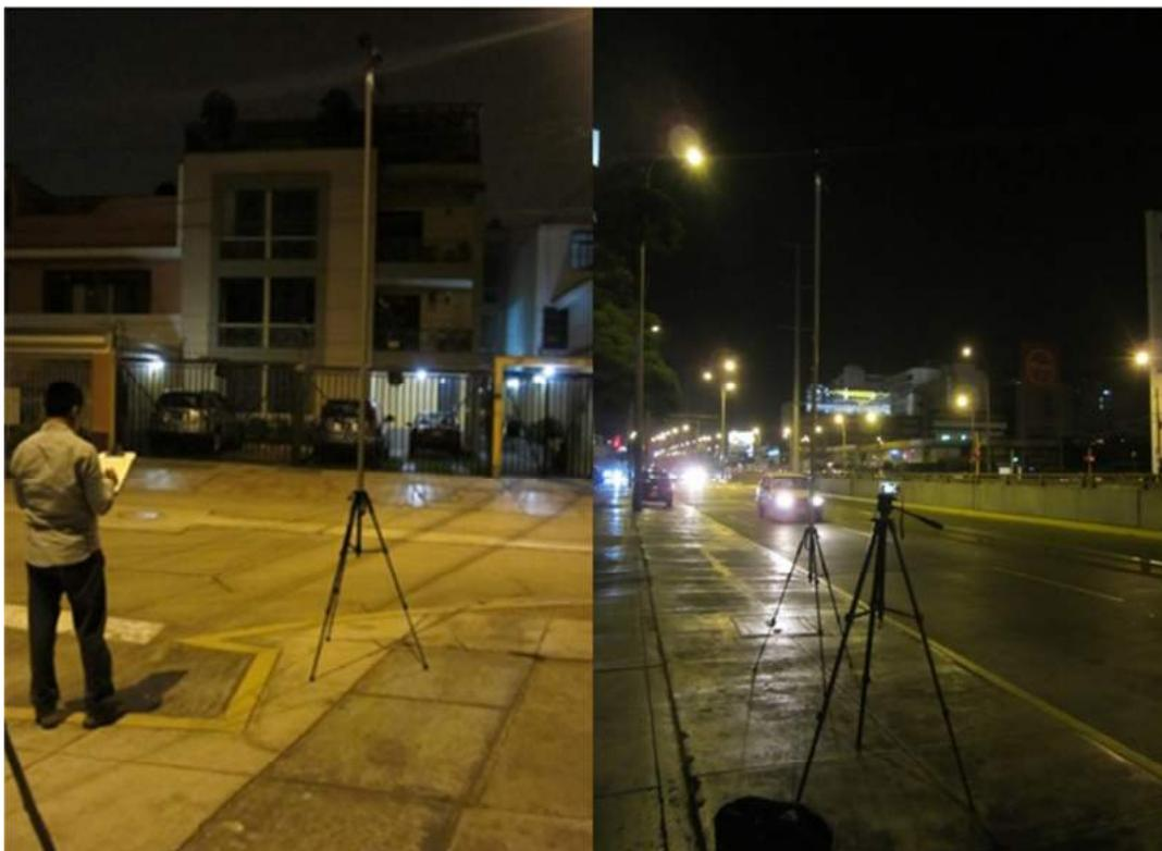
Figura 15. Conteo vehicular con tablero (izquierda) y con cámara (derecha)
