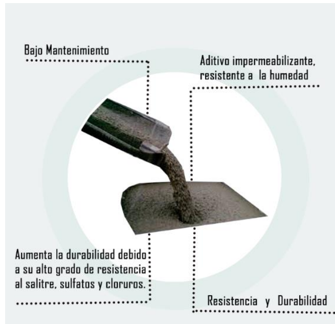
Figura 254 Concreto con aditivo impermeabilizante
