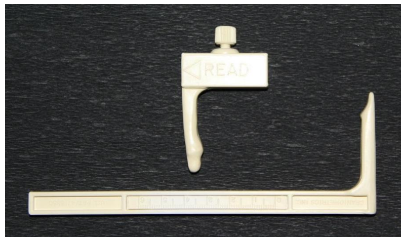
Figura 4: Craneómetro de material plástico fabricado en Estados Unidos con código U.S. Pat. 4718850
