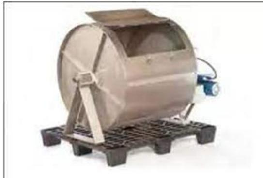
*Ilustración 14. Máquina secadora de granos*
