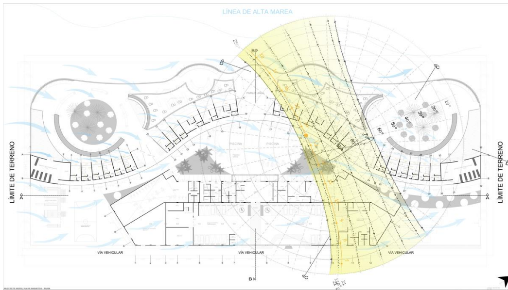
Figura 54: Comportamiento de viento enfriamiento por evaporización piscina central , recorrido solar y protección por vegetación
